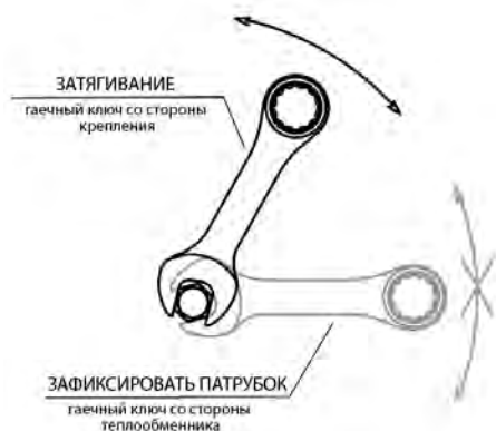
Рис. 5. Подключение к системе подачи теплоносителя
